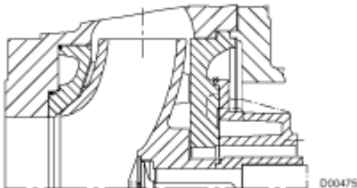
Рис. 4.3-2 Крышка корпуса с привинченным сальниковым уплотнением корпуса (корпус в исполнении 3); исполнение по материалу: GH, H
