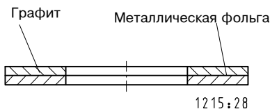
Рис. 14 Уплотнительное кольцо с металлической фольгой
